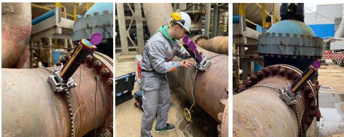
Рисунок 5 – Испытание металла элементов технологической линии 30" P72.107DB16.
