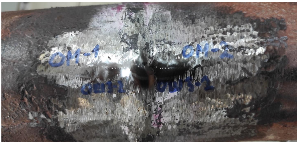
Рисунок 4 – Участок змеевика печи со сварным соединением после испытаний индентированием.
