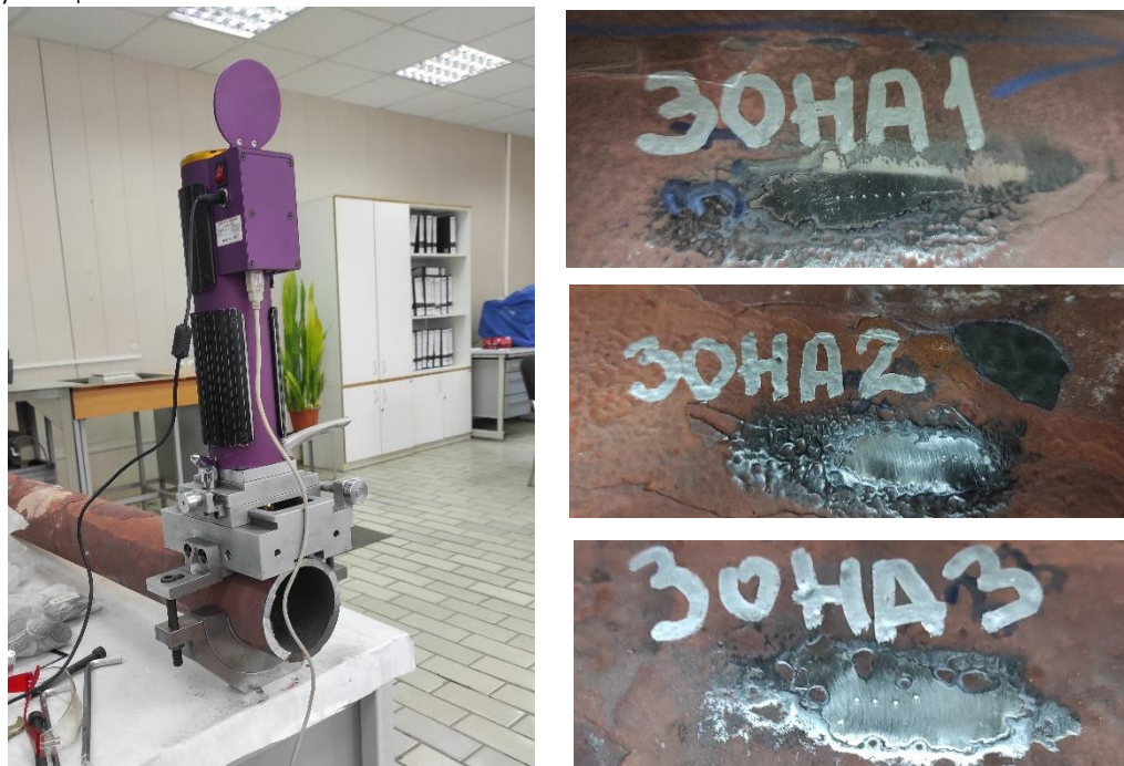
Рисунок 1 – Испытание участков (ПЗ.2-1) змеевика печи в лаборатории завода
