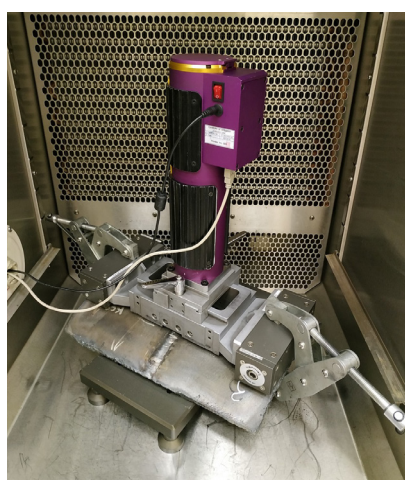
Рис. 1. Прибор AIS-3000HD на темплете из кольцевого сварного соединения в климатической камере Fig. 1. AIS-3000HD on a girth welded joint template in a climatic test chamber
