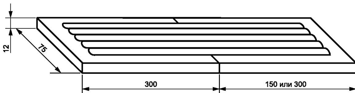
Рисунок 1 — Испытательный образец
